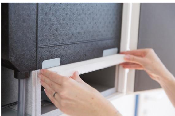
Neuen sauberen Filter einsetzen. Auf die korrekte Einbaulage achten.
