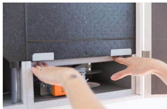
Filter ganz bis zur Geräterückwand hineinschieben.
