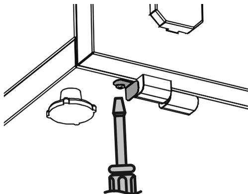
Lösen Sie die Riegel, trennen Sie das Erdungskabel und nehmen Sie die Wartungsklappe ab.
