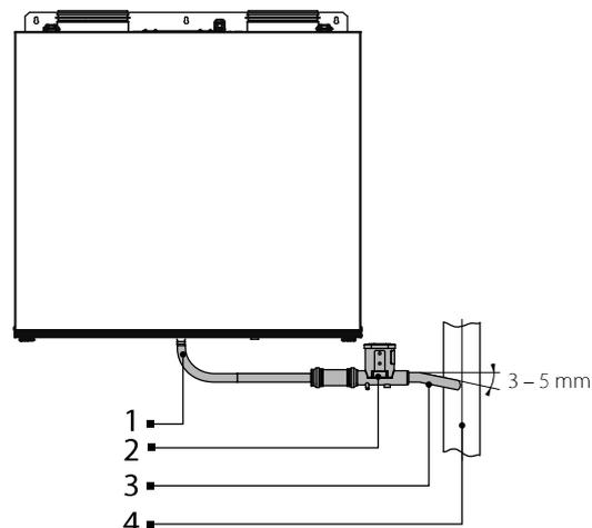
1: Ablaufstutzen 2: Siphon 3: Anschlussrohr 4: Abwassersystem
