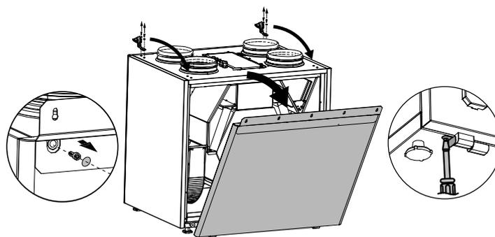
Setzen Sie die Wartungsklappe auf der Gegenseite ein und schließen Sie das Erdungskabel an. Setzen Sie die Rückseite ein. Befestigen Sie den Scharnierstopper.
