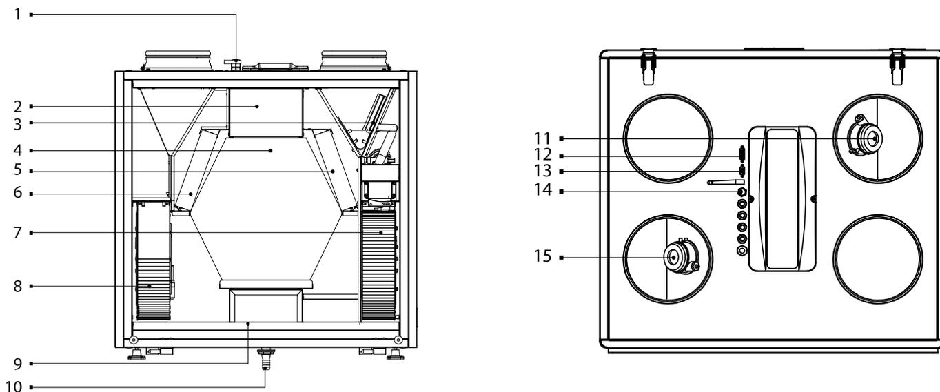
**1:** luftdichte Kabeldurchführungen **2:** Steuereinheit **3:** Bypassklappe (außer KOMFORT EC S(1) 160(-E) -Modelle) **4:** Gegenstrom-Wärmetauscher **5:** Abluftfilter **6:** Zuluftfilter **7:** Zuluftventilator **8:** Abluftventilator **9:** Auffangwanne **10:** Kondensatablauf
