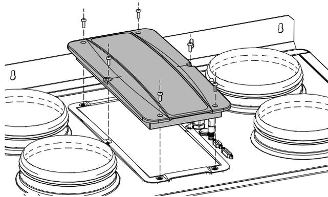
Führen Sie die Kabel zur Steuereinheit durch die Kabeldurchführungen in der Anlage. Führen Sie die elektrischen Anschlüsse gemäß dem Anschlusschema durch.
