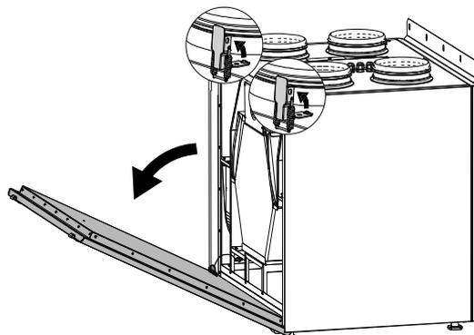
Schrauben Sie die Riegel ab und bringen Sie sie auf der Gegenseite der Anlage an. Nehmen Sie die Rückseite ab und lösen Sie die drei Schrauben, die sich unter den Gummiplättchen befinden.
