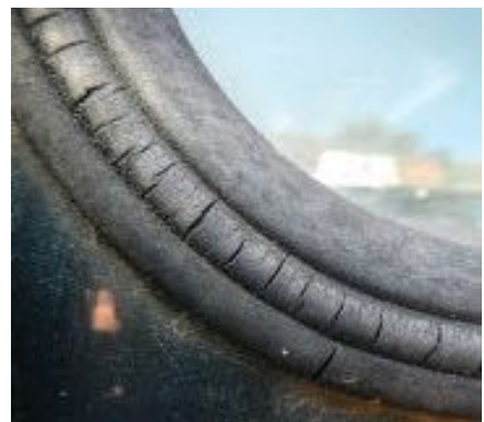
Abbildung 33 - Symbolfoto einer porösen Dichtung am Beispiel eines Autofensters
