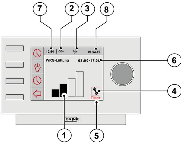
Während der Betriebsart 'Betrieb' des Renovent Sky werden im Display des "Brink Air control" einige verschiedene Werte angezeigt:
