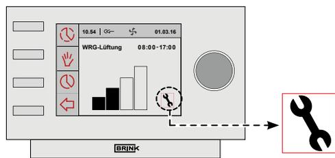
Wenn das Gerät eine nicht-sperrende Störung erkennt, wird es noch (beschränkt) weiterhin funktionieren. Im Display wird das Störungssymbol (Schlüssel) angezeigt. In dem Menü "Meldungen" kann diese Störung ausgelesen werden.
