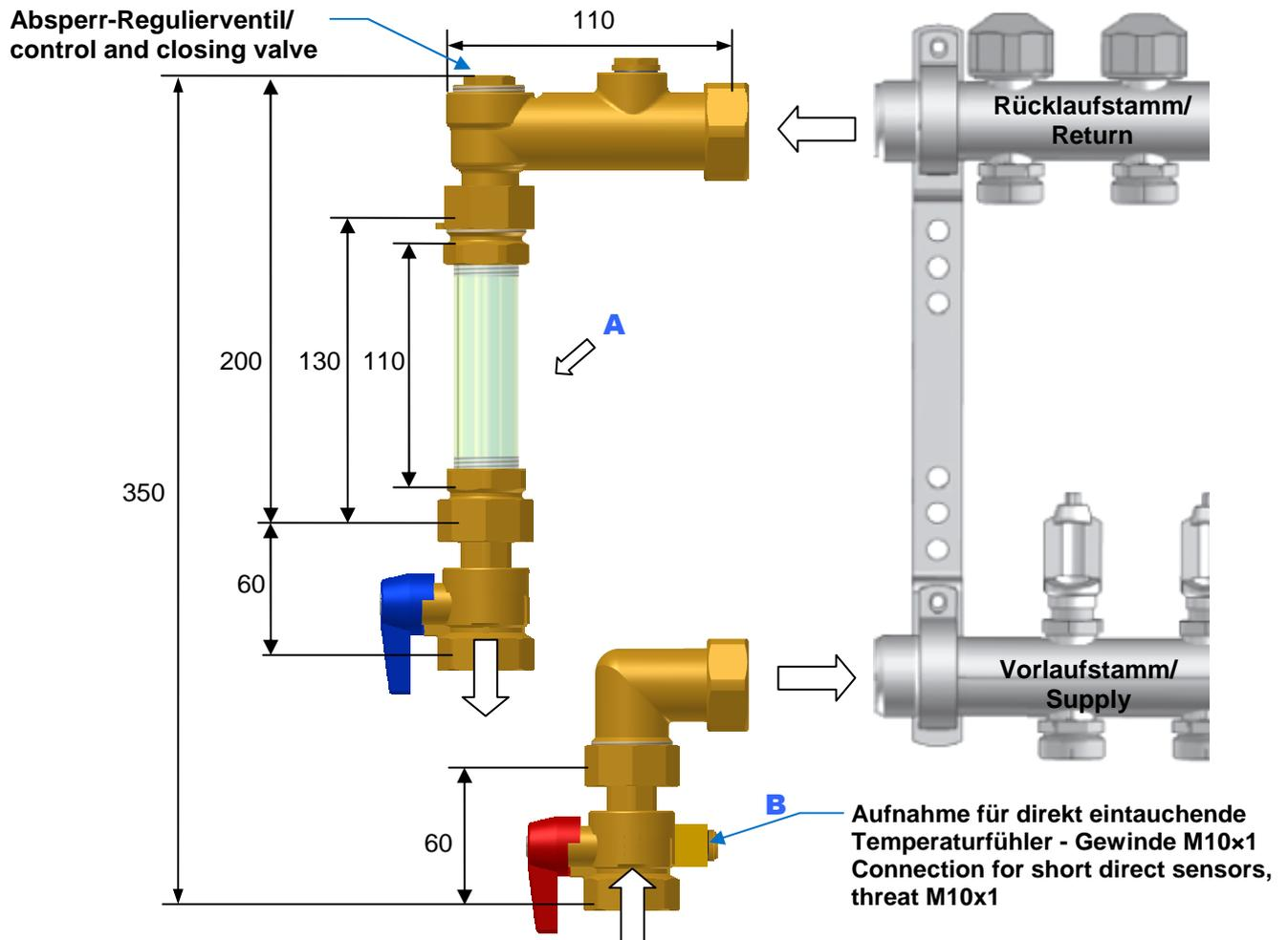
Das Roth Wärmemengenzähler-Set senkrecht kann in Kombination mit dem Roth Heizkreisverteiler Universal oder dem Roth Heizkreisverteiler mit Durchflussanzeige eingesetzt werden.
