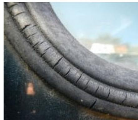
Abb. 19 Symbolfoto einer porösen Dichtung am Beispiel eines Autofensters
